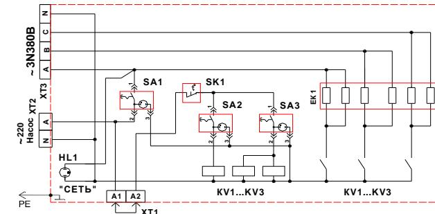
Рис. 4 ЭВПМ-9,ЭВПМ-12 (3 реле , 6 нагревателей) Схема электрическая принципиальная.
