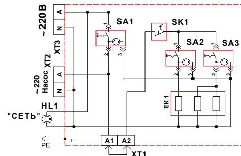
Рис. 2 ЭВПМ-3 Схема электрическая принципиальная.
