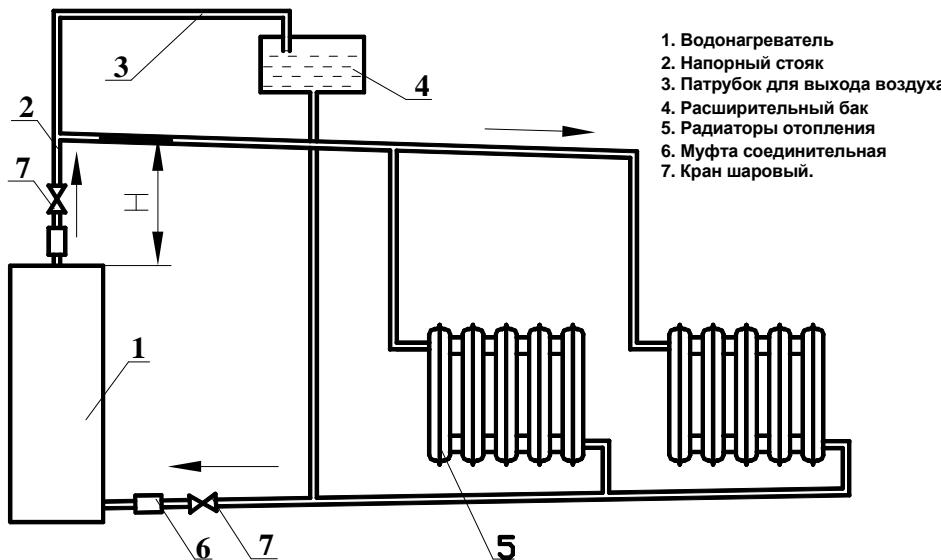
Примечание: Высота Н определяет рабочее давление системы отопления.
