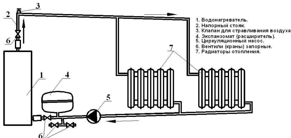
Рис. 7 Схема включения ЭВПМ-3...24 в циркуляционную отопительную систему.
